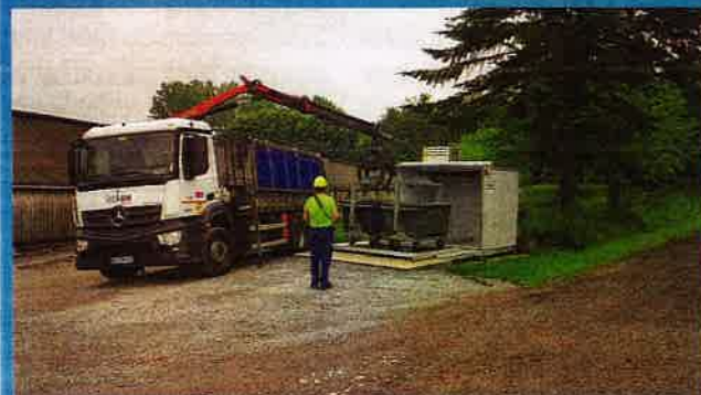
Le bac est repris par la grue du camion d'équarrissage, commandée par un joystick puis est reposé sur le plateau. ©A. Puybasset
