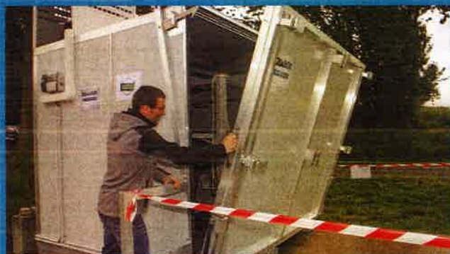
Déverrouillée via une boîte à code, la porte à pont-levis est ouverte mécaniquement et abaissée au sol. ©A. Puybasset
