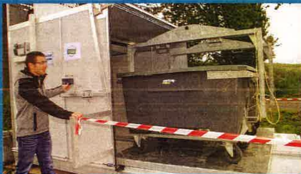
L'avancée du chariot est commandée en maintenant l'appui sur un bouton, ce qui l'oblige l'opérateur à rester éloigné du plateau par sécurité, protégé par une barrière. ©A. Puybasset
